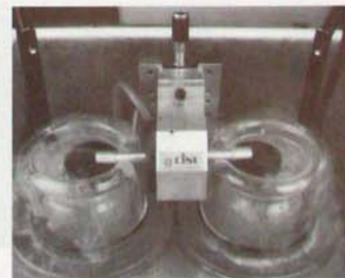
Il nuovo rotore con cuscinetti superconduttori a levitazione magnetica per usi spaziali.
