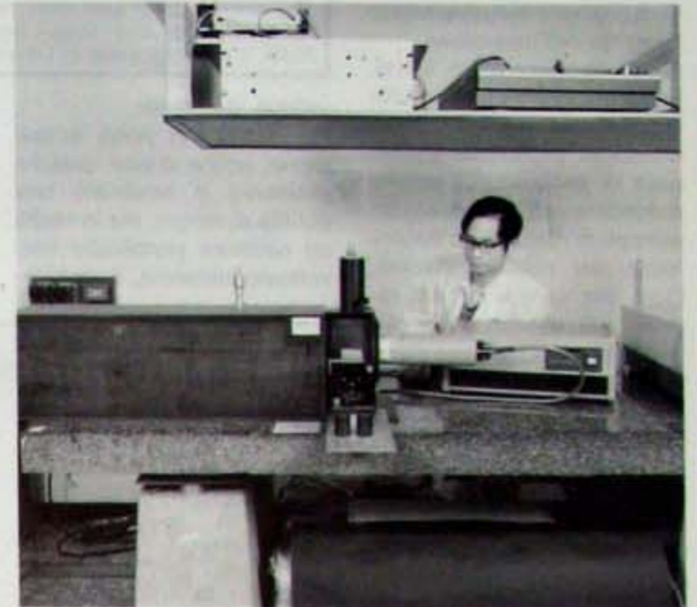
Zhou Fuxin al sistema CARS per la misura della concentrazione dei gas in caldaia.
