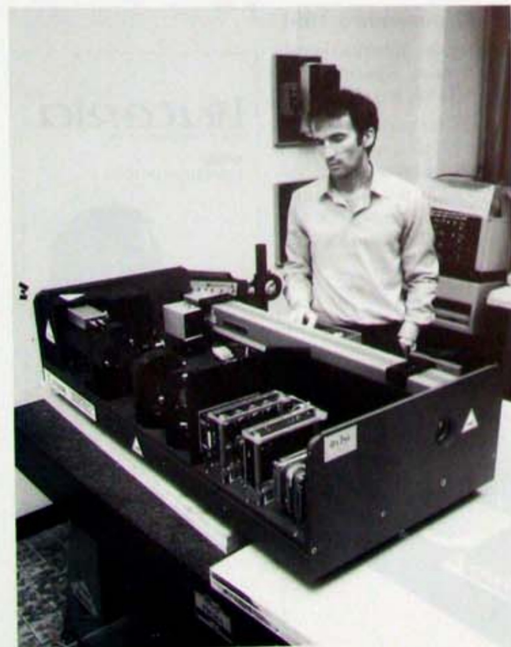
Alessio Martinelli al velocimetro laser Doppler, per la misura della velocità dei gas in camera di combustione.
