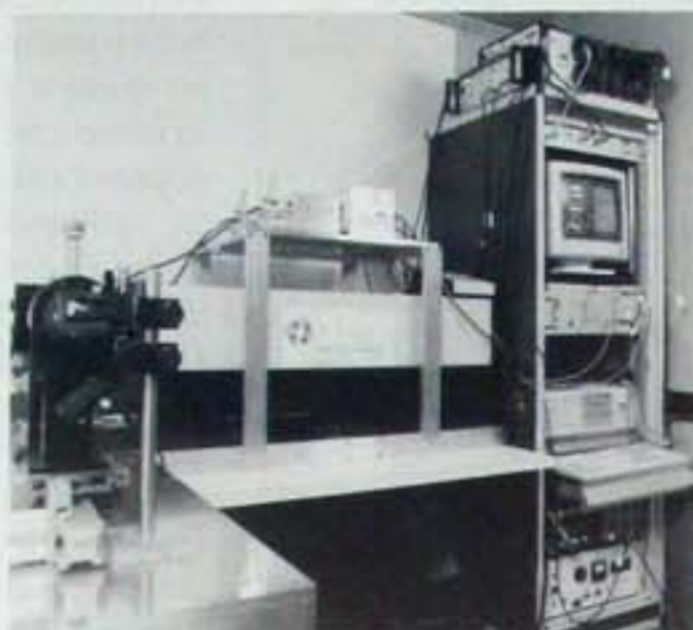
Strumento elettroottico per l'analisi spettroscopica di archi elettrici di potenza.
